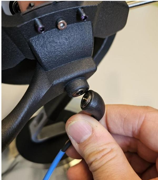
8. Verbinden Sie das Audiokabel mit dem smartALF Gehäuse. Achten Sie darauf, die richtige Seite anzuschließen. Wenn Sie von vorne auf den smartALF schauen (vorne ist da wo der USB-Anschluss sitzt) befindet sich die rechte Seite (rote Markierung) links vom Gehäuse. Bei an den Rechner angeschlossenem smartALF leuchten die Plexiglasringe in rot und blau um die Seite anzuzeigen. Zusätzlich gibt es eine Farbmarkierung am Kabel (rot für rechts und blau für die linke Seite).
